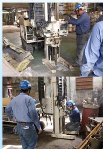
工廠污染調查以鑽機進行土壤採樣
