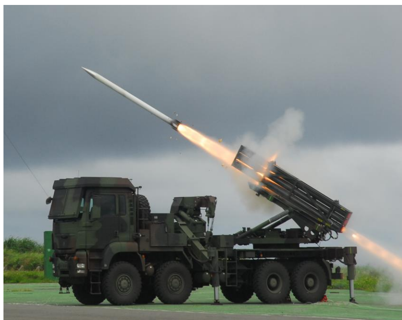
圖 4：國產雷霆 2000 多管火箭系統 （目前最大射程 45 公里；未來增程型 100、300 公里）
